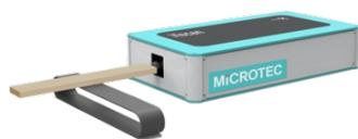
Viscan Strength Grader est le meilleur scanner optique à interféromètre laser de sa catégorie pour déterminer la MOE du bois. Il répond à toutes les certifications de résistance en vigueur dans le monde. Viscan mesure la fréquence de résonance de la planche grâce à un vibromètre laser haute performance qui fonctionne indépendamment des interférences environnementales telles que le bruit.
