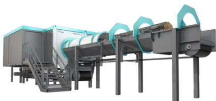
CT Log, il tomografo computerizzato di MiCROTEC fornisce una ricostruzione completa delle caratteristiche interne dei tronchi, consentendo di classificare e ordinare i tronchi in base alla qualità e di ottimizzare la soluzione di taglio con il valore più elevato in tempo reale.
